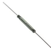
I contatti magnetici sono formati da un contatto che si chiude quando nelle vicinanze è presente una calamita. Sono di solito impiegati negli impianti d'allarme per identificare l'apertura di porte o finestre.
