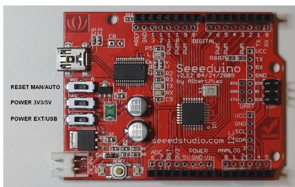
La scheda viene connessa al PC con il solito cavo USB (con connettore micro dal lato scheda), la procedura di avvio e di programmazione è identica alla scheda Arduino originaria come descritto in precedenza.
